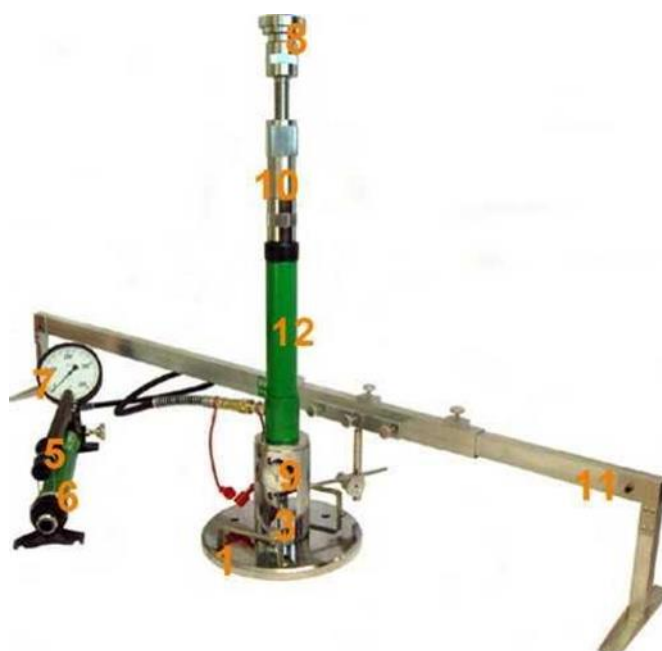
Rys. 1.2 Aparatura VSS z jednopunktowym pomiarem przemieszczenia płyty
