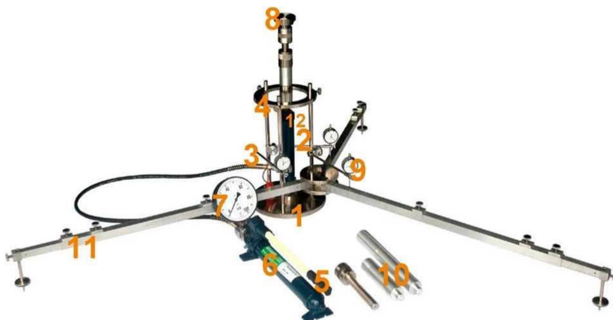
Rys. 1.1. Aparatura VSS z trzypunktowym pomiarem przemieszczenia płyty
