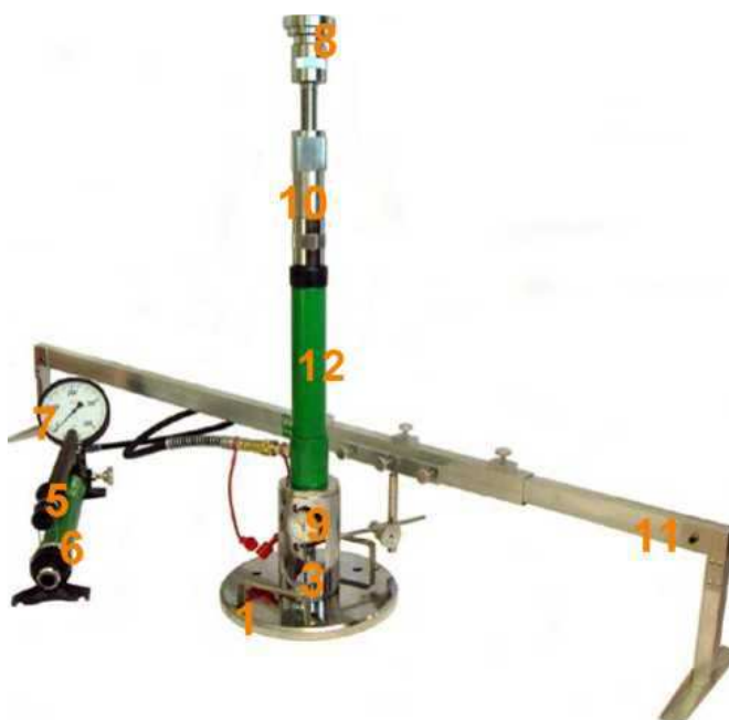
Rys. 1.2 Aparatura VSS z jednopunktowym pomiarem przemieszczenia płyty
