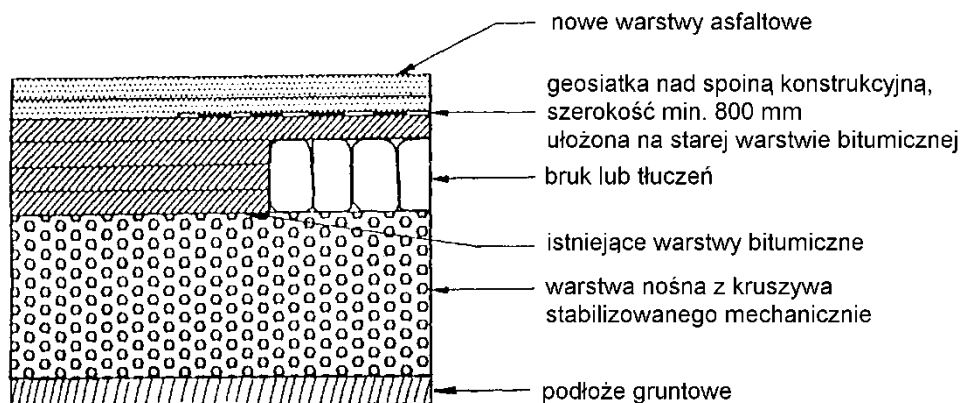
Rys. 5. Wzmocnienie nawierzchni asfaltowej w strefie poszerzenia nawierzchni
