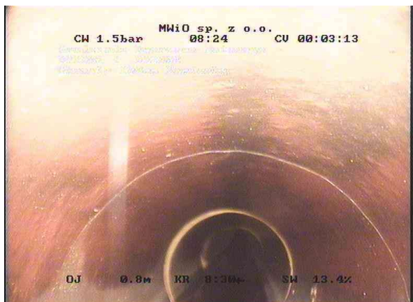
e8ebae6b-7fae-45d3-9fb5-1b15f8b4c41f_20241031_083201_171.jpg, 00:02:43, 0.82 Szczelina, pęknięcie obwodowe, 1mm szeroki od 12 godz. do
