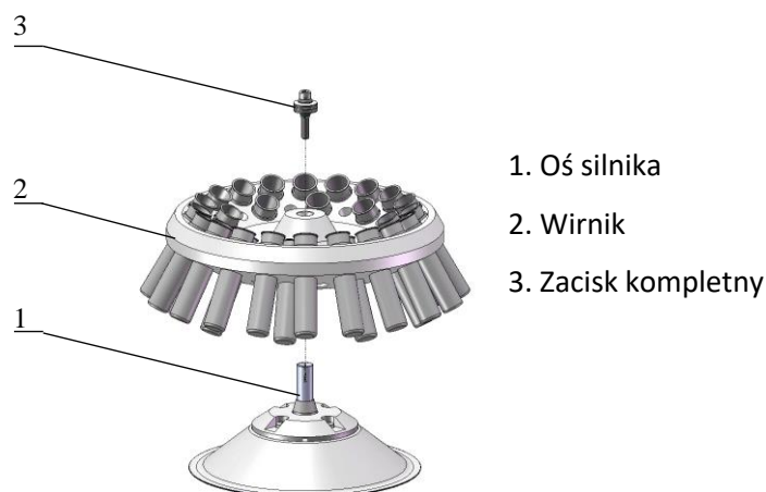
Rys.3. Elementy zespołu wirnika
