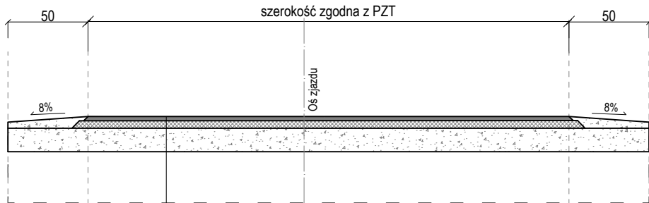
Przekrój normalny przez zjazd z betonu asfaltowego [BA] A-A odcinek 0+000-0+163
